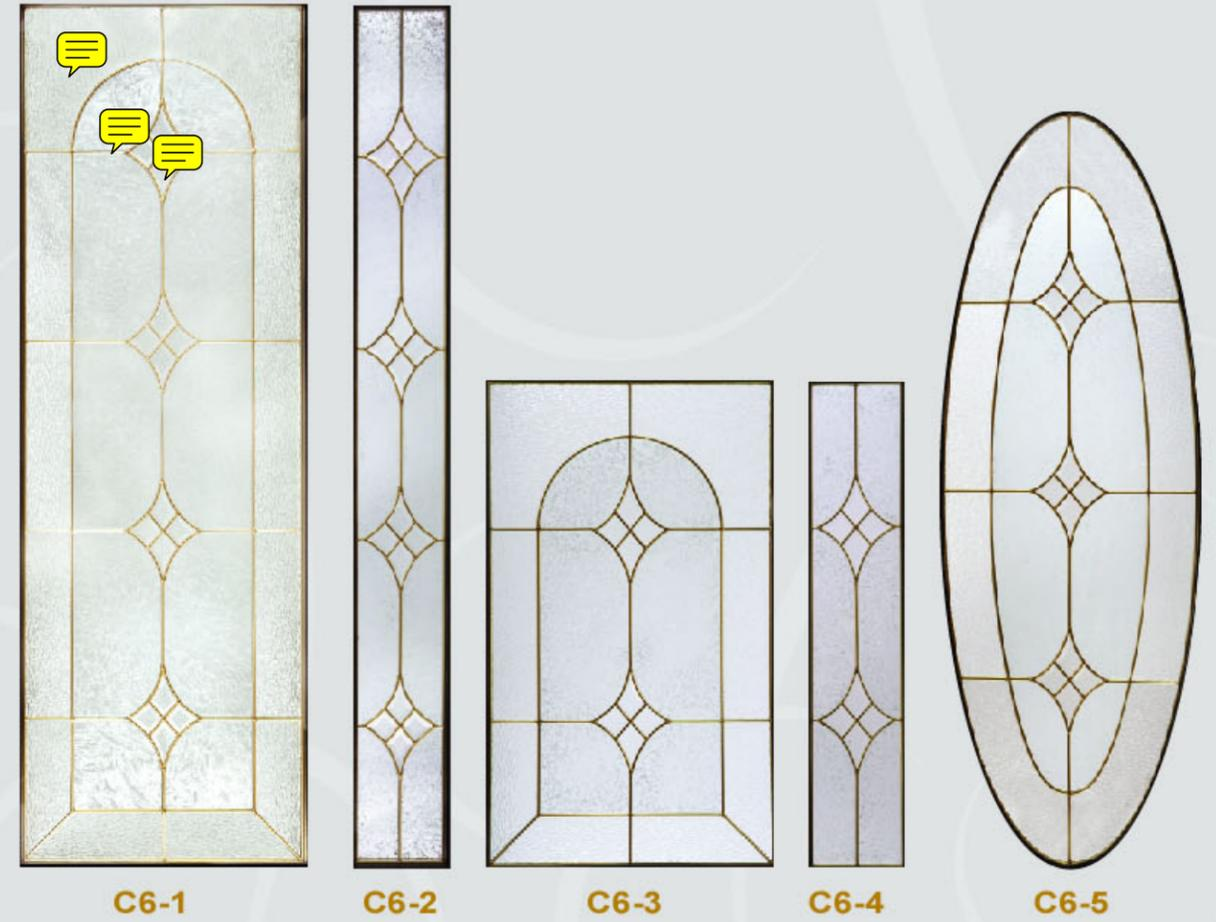
中空镶嵌玻璃由三层玻璃密封而成。两侧面为钢化玻璃，中间层用铜条将透明、碎花等磨边玻璃，采用手工镶嵌工艺拼装在一起，焊接成具有多种艺术风格、民族特色图案的镶嵌结构的产品。它是一种高级、新型的装饰材料，具有豪华靓丽、富丽堂皇、保温隔音、抗撞安全、无尘无霜等特点，风靡国内外建筑装饰材料市场。
